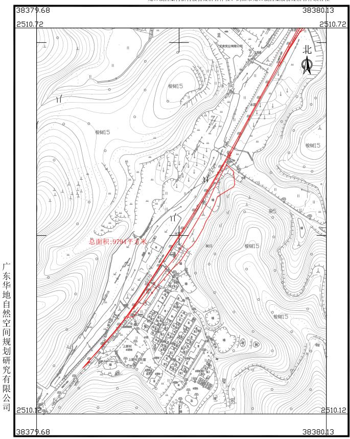
2025年4月数字化制图 2000国家大地坐标系,中央子午线114度 TD/T 1008-2007土地勘测定界规程 1:3000 制图员: 林楚云 检查员: 杨 团
