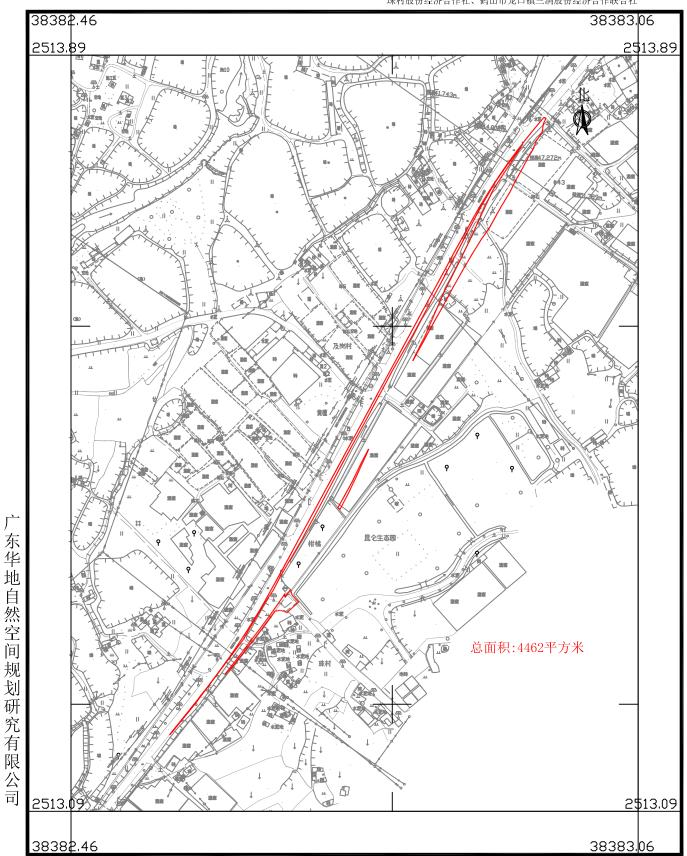
2025年4月数字化制图 2000国家大地坐标系,中央子午线114度 TD/T 1008-2007土地勘测定界规程 1:4000 制图员: 林楚云 检查员: 杨 团
